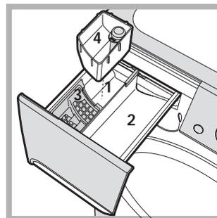
Эта функция служит для удаления наиболее трудных пятен. Вставьте дополнительный прилагающийся дозатор 4 в дозатор 1. При заливке отбеливателя не превышайте "макс." уровень, указанный на стержне в центре (см. схему). Для выполнения только отбеливания залейте
